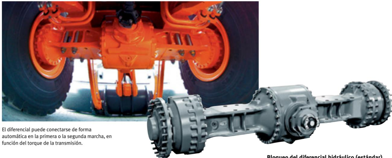
El diferencial puede conectarse de forma automática en la primera o la segunda marcha, en función del torque de la transmisión.
